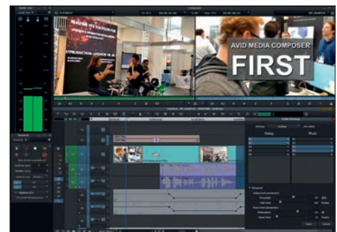
Auch das neue Ducking-Tool ist vorhanden, das man mit einem Rechtsklick auf die Timeline aufrufen kann, um automatische Lautstärke-Keyframes zu generieren, um so z.B. beim Sprechertext die Musik runterzuregeln.
