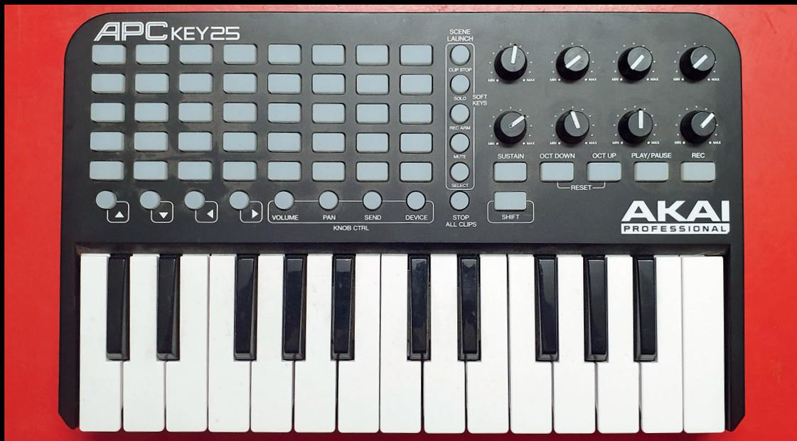
Auch dieses Akai-MIDI-Keyboard lässt sich hervorragend zur VMIX-Steuerung einsetzen. Mit den Drehreglern kann man beispielsweise die Lautstärke der Audiokanäle regeln. Sogar der Zustand der Tastenbeleuchtung lässt sich mithilfe von Activators programmieren.
