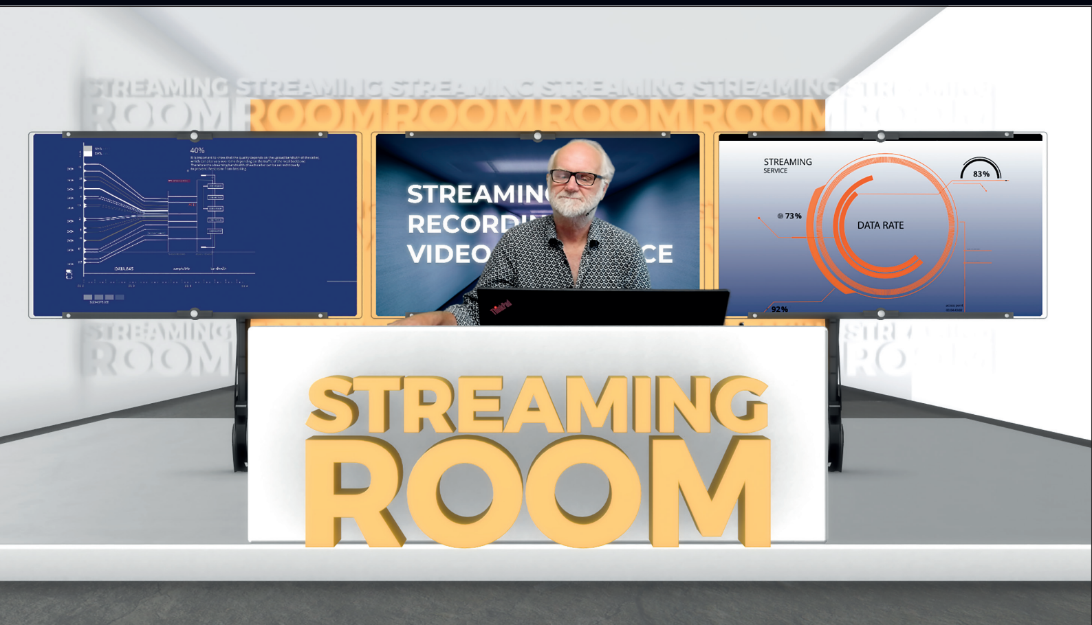
Dieser vMix Streaming Room wurde in After Effects mit Element 3D gebaut und in 2 PNGs exportiert. Die Alpha-Masken der Displays erlauben es, drei Videoquellen dahinter einzupassen. Davor die gekeyte Greenbox-Ebene mit Moderator und auf dem obersten Layer der Streaming Room Desk.
